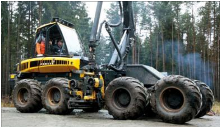
Abb. 3: Mit dem neuen Kran kann sehr nah an der Maschine gearbeitet werden
