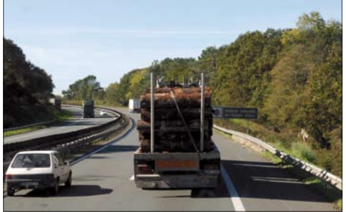
Abb. 13: Spanier und Franzosen sichern ihr Kurzholz mit einem diagonal gespannten Gurt
